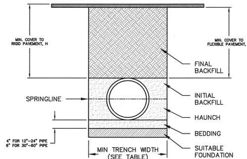
TABLE 1, RECOMMENDED MINIMUM TRENCH WIDTHS
